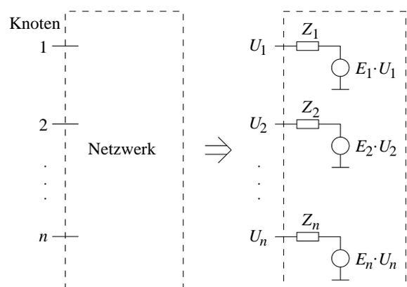
Bild 1: Ersatzschaltung zur Bestimmung der Stabilität
