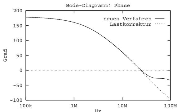
Bild 3(b): Phasengang der Übertragungsfunktion
