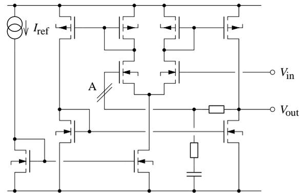
Bild 2: Beispiel: Operationsverstärker mit Gegenkopplung
